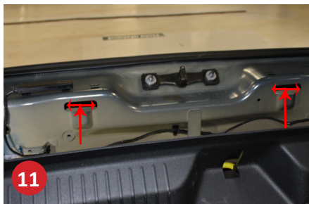
11 Bagpanel. Demonter beklædning, behandl via eks. Huller i alle retninger.
