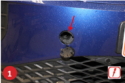
1 Slæbe anordning i frontkofanger behandles via eks. Proppet hul.
