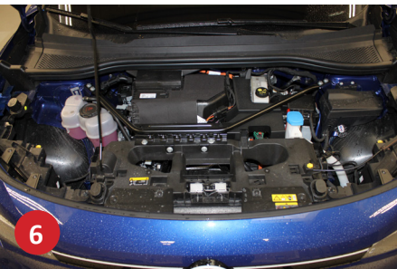
6 Motorrum. Behandl længdevanger, langs kanten v/forskærme, tårne, samt hængsler v/fronhjelm. N.B. Ingen behandling på orangekabler.
