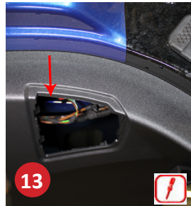
12 Bagklap. Demonter flapper, behandl via eks. Hul. Bemærk dobbeltplade.
