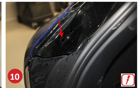
10 Bagskærm fra bagagerum. Afmonter afstandsklods v/ baglygte, behandl via skruehul. Behandles også fra under side, se billede 22.
