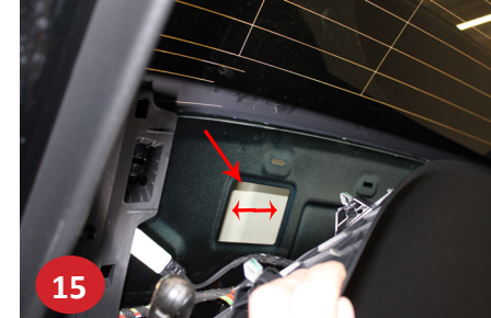
14 Bagklap foroven. Vip beklædning ud ved ruden, behandl med forsigtighed via eks. Huller.
