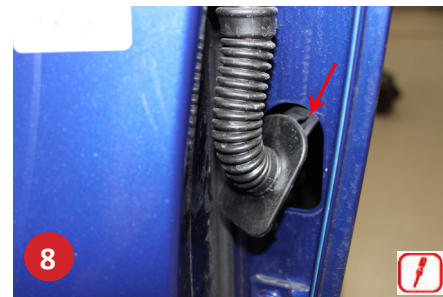
8 Bag dør. Vip ledningsgennemføring ud forneden og træk ned, behandl via eks. Proppet hul.
