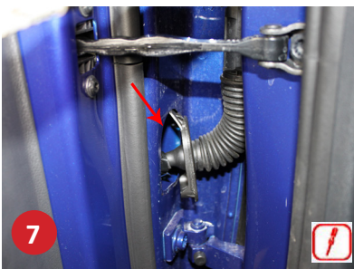
7 Fordør. Vip ledningsgennemføring ud forneden og træk ned, behandl via eks. proppet hul. Ingen behandling mod kabinen pga. trykensor for airbag.
