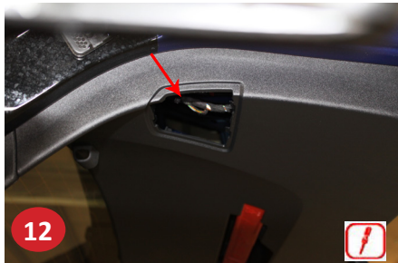
12 Bagklap. Demonter flapper, behandl via eks. Hul. Bemærk dobbeltplade.
