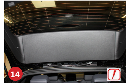
14 Bagklap foroven. Vip beklædning ud ved ruden, behandl med forsigtighed via eks. Huller.
